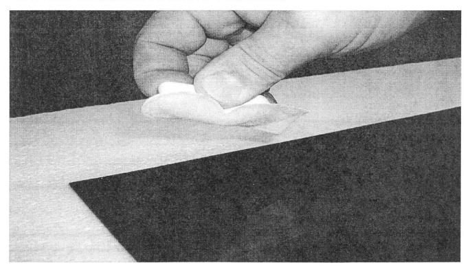
**STEP 2**: PINCH AKTIVATOR APLICATOR AS SHOWN ABOVE TO RELEASE THE COMPOUND INSIDE
