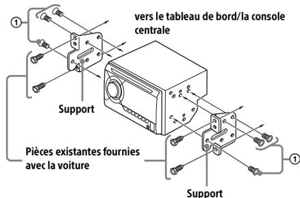
Lors de la fixation de cet appareil dans les supports pré-installés du véhicule, vissez les vis ① fournies dans les trous appropriés selon le modèle de véhicule : T pour TOYOTA, M pour MITSUBISHI et N pour NISSAN.
