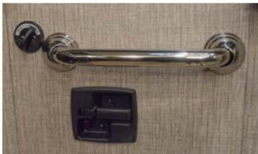
4. Saisissez et tirez la languette pour retirer le couvercle de l'échelle et mettez-le de côté.
