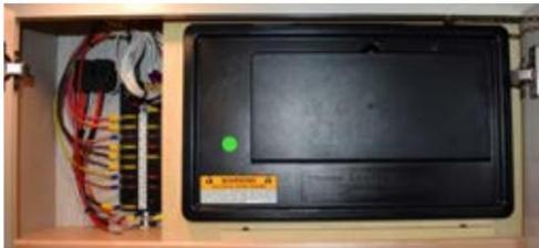
Un panneau de fusibles supplémentaire est situé sous le panneau d'accès au sol recouvert de moquette entre les sièges conducteur et passager et/ou sous le revêtement recouvert de moquette derrière le siège conducteur. Il peut également être situé sous un tableau de bord amovible du côté passager de la cabine.
