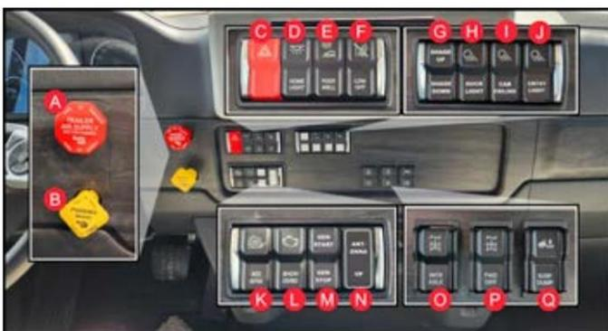
Les commutateurs montés sur le tableau de bord sont rétroéclairés pour éclairer le texte et l'icône sur le commutateur. Appuyez sur la moitié supérieure de l'interrupteur pour allumer ou éteindre la ou les lampes souhaitées. Si les lumières ont une fonction de gradation, maintenez l'interrupteur enfoncé pour faire passer la lumière entre clair et faible.
