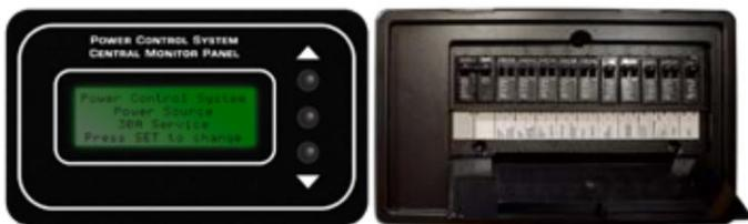
Le module de commande EMS détecte automatiquement la puissance disponible fournie à l'autocar. Le module détermine s'il est connecté à un 50 Amp (240 Volt) ou au générateur. Sur un service de 120 volts, il est incapable de déterminer si la source fournit une alimentation à quai de 30, 20 ou 15 ampères. Selon la puissance disponible, il peut contrôler jusqu'à sept charges.
