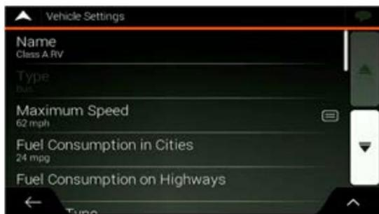
Les informations sur la consommation de carburant et le type de moteur sont utilisées pour calculer et estimer la quantité de carburant nécessaire ainsi que la quantité approximative de CO2 produite. Les « Paramètres étendus du véhicule » peuvent également être modifiés pour les types de profil de véhicule plus grands.
