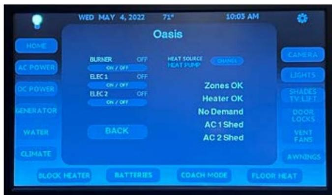
L'écran de contrôle Oasis n'est accessible qu'à partir de l'écran Climate All et permet à l'utilisateur de contrôler le brûleur du système de chauffage hydronique Oasis et les deux éléments chauffants électriques du système de chauffage hydronique.
