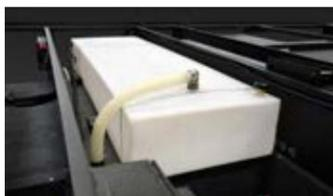
La vanne de remplissage d'eau douce située dans le compartiment de service près du branchement d'eau détermine si l'eau de la ville passe par le système d'eau ou dans le réservoir d'eau douce. L'excès d'eau sera évacué d'un tuyau d'évent de trop-plein vers le sol lorsque la capacité du réservoir sera atteinte. Ce tuyau est installé dans le réservoir d'eau douce pour empêcher la rupture du réservoir par débordement.
