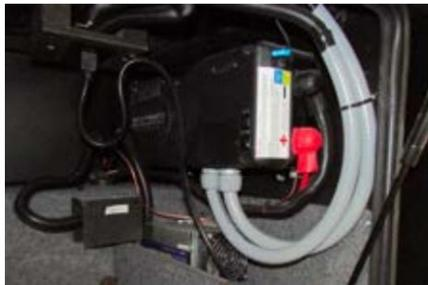
L'onduleur peut assurer la charge de la batterie tandis que le 120 volts est fourni via le générateur ou l'alimentation à quai. L'onduleur effectue cette action en utilisant le transformateur pour diminuer la tension et redresser le courant alternatif en tension de courant continu utilisable. Ceci est régulé par un circuit de détection interne basé sur l'état de charge du groupe de batteries et plusieurs autres facteurs, en fonction de la marque et du type d'onduleur particulier de l'autocar.
