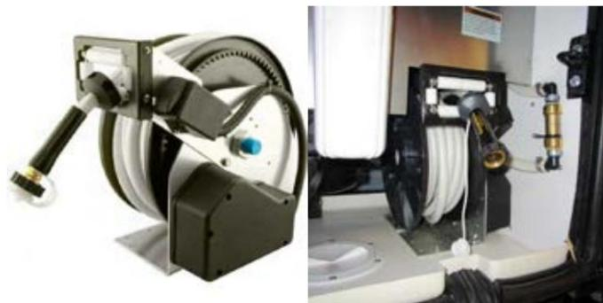
Le système d'eau douce de l'autocar est conçu pour fonctionner à un maximum de 60 PSI. Des niveaux de pression d'eau supérieurs à ce niveau peuvent endommager la plomberie d'eau douce dans l'autocar. Si jamais la pression de l'eau dépasse 60 PSI, un régulateur de pression doit être installé pour réduire la pression entrante, ou remplir le réservoir d'eau douce et utiliser la pompe à eau interne pour alimenter l'autocar en eau.
