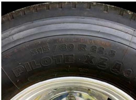
Cette taille de pneu est 315 / 80 R 22.5. A partir de cette taille, nous pouvons déterminer les dimensions physiques du pneu, ainsi que sa construction de base. La taille des pneus se décompose comme suit :
