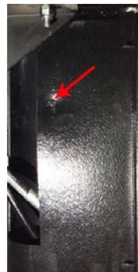
3. Ne retirez pas les vis sur le côté plat du couvercle. Au lieu de cela, retirez les vis sur le côté du couvercle, ce qui permet de retirer tout le couvercle.
