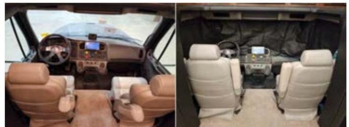
Pour installer le rideau d'intimité du pare-brise, commencez par accrocher les clips en J à l'arrière du rideau sur la tige au-dessus du pare-brise. Ensuite, un par un, appuyez sur chaque bouton en place jusqu'à ce que l'ensemble du rideau recouvre le pare-brise, ainsi que les vitres du conducteur et du passager.
