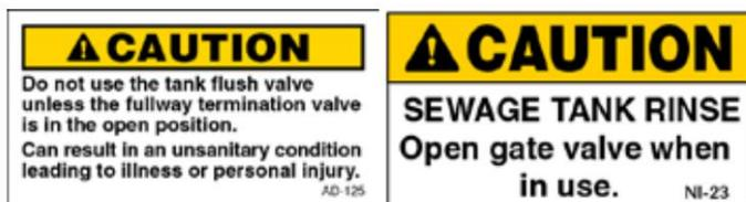
Ensuite, débranchez le tuyau d'eau douce et fermez le robinet-vanne. S'il reste des solides à l'intérieur du réservoir, remplissez le réservoir d'eaux usées avec environ dix gallons d'eau et retenez le produit chimique du réservoir à travers les selles. Pendant que vous voyagez, l'agitation de l'eau devrait aider à liquéfier les solides restants dans le réservoir. Vous pouvez vider à nouveau le réservoir d'eaux usées à votre prochaine destination.
