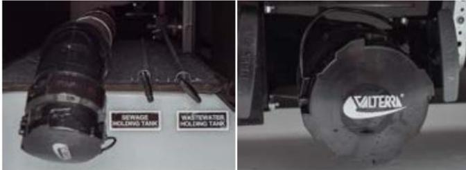
La conduite d'égout doit être solidement bouchée pendant l'utilisation de l'auto-confinement pour empêcher les fuites de déchets sur le sol ou la chaussée.
