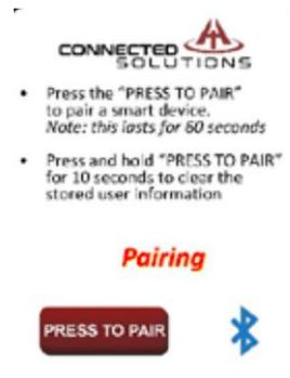
8. Activez le mode d'appairage en appuyant sur le bouton "PRESS TO PAIR" sur le module ATCNET avec un trombone ou une épingle. Cela permet l'appairage pendant 60 secondes.
