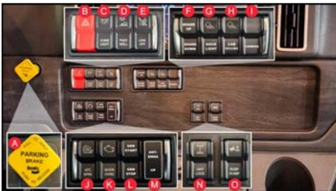
Les commutateurs montés sur le tableau de bord sont rétroéclairés pour éclairer le texte et l'icône sur le commutateur. Appuyez sur la moitié supérieure de l'interrupteur pour allumer ou éteindre la ou les lampes souhaitées. Si les lumières ont une fonction de gradation, maintenez l'interrupteur enfoncé pour faire passer la lumière entre clair et faible.
