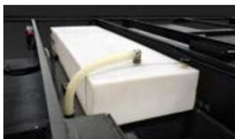
La vanne de remplissage d'eau douce située dans le compartiment de service près du branchement d'eau détermine si l'eau de la ville passe par le système d'eau ou dans le réservoir d'eau douce. L'excès d'eau sera évacué d'un tuyau d'évent de trop-plein vers le sol lorsque la capacité du réservoir sera atteinte. Ce tuyau est installé dans le réservoir d'eau douce pour empêcher la rupture du réservoir par débordement.
