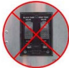
Ne tirez pas sur le robinet-vanne du réservoir de rétention et n'actionnez pas l'interrupteur de la soupape de décharge électrique (le cas échéant) lorsque le capuchon de protection est installé sur le tuyau. Vidangez toujours le réservoir dans une entrée d'égout ou une station de vidange acceptable.
