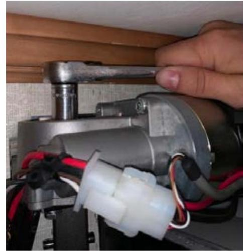
Sur le moteur de gauche, tournez le boulon dans le sens antihoraire pour rétracter la pièce du côté gauche. Tournez le boulon dans le sens des aiguilles d'une montre pour étendre la pièce sur le côté gauche.
