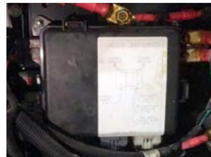
Exemple de panneau de fusibles de châssis Freightliner
