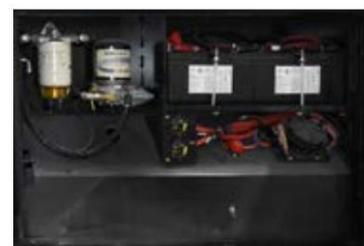
Les batteries du châssis sont isolées des batteries du bus. Cela empêche les batteries du châssis d'être vidangées par l'équipement intérieur de 12 volts, permettant une tension suffisante pour l'allumage du moteur.
