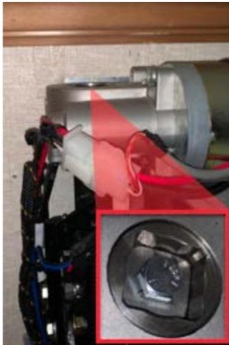
Pour rétracter le coulisseau, atteignez le fascia à l'aide d'un cliquet et d'une douille. Placez-le sur la tête de boulon et tournez le boulon. Au fur et à mesure que le boulon est tourné, le coulisseau commence à bouger.
