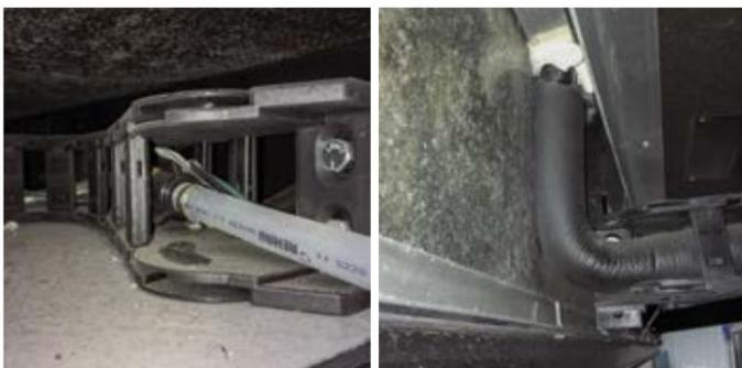
Raccorder le tuyau du car au réseau d'eau de ville (si équipé d'un enrouleur). Ouvrez la vanne d'alimentation à la source d'eau et ouvrez chacun des robinets pour éliminer toute poche d'air dans les conduites de plomberie de l'autocar. Une fois que l'eau coule librement, fermez le(s) robinet(s).
