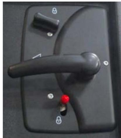
Certains autocars peuvent être équipés pour verrouiller automatiquement la porte d'entrée avant lorsque le frein de stationnement est desserré pour le déplacement ou pour déverrouiller la porte d'entrée avant lorsque le frein de stationnement est engagé.
