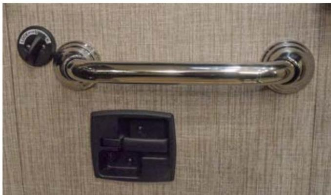
4. Saisissez et tirez la languette pour retirer le couvercle de l'échelle et mettez-le de côté.
