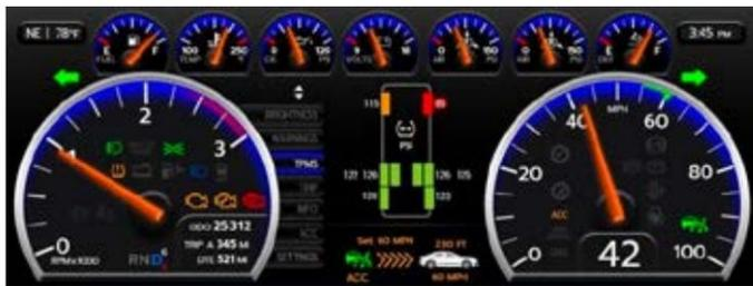
L'affichage sélectionnable est navigué à l'aide des touches fléchées haut et bas sur la palette de droite du volant. Les éléments suivants peuvent être affichés dans la zone sélectionnable :
