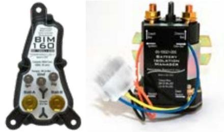
Tous les autocars diesel Kountry Star, Super Star, Dutch Star et Ventana actuels utilisent un gestionnaire d'isolation de batterie (BIM) tout-en-un de Precision Circuits. Le BIM surveille à la fois le châssis et la batterie interne et est le seul endroit dans l'autocar où ils fusionnent tous les deux. Le BIM ne fonctionne que lorsque le moteur ou le générateur est en marche ou lorsque l'autocar est connecté à l'alimentation à quai.
