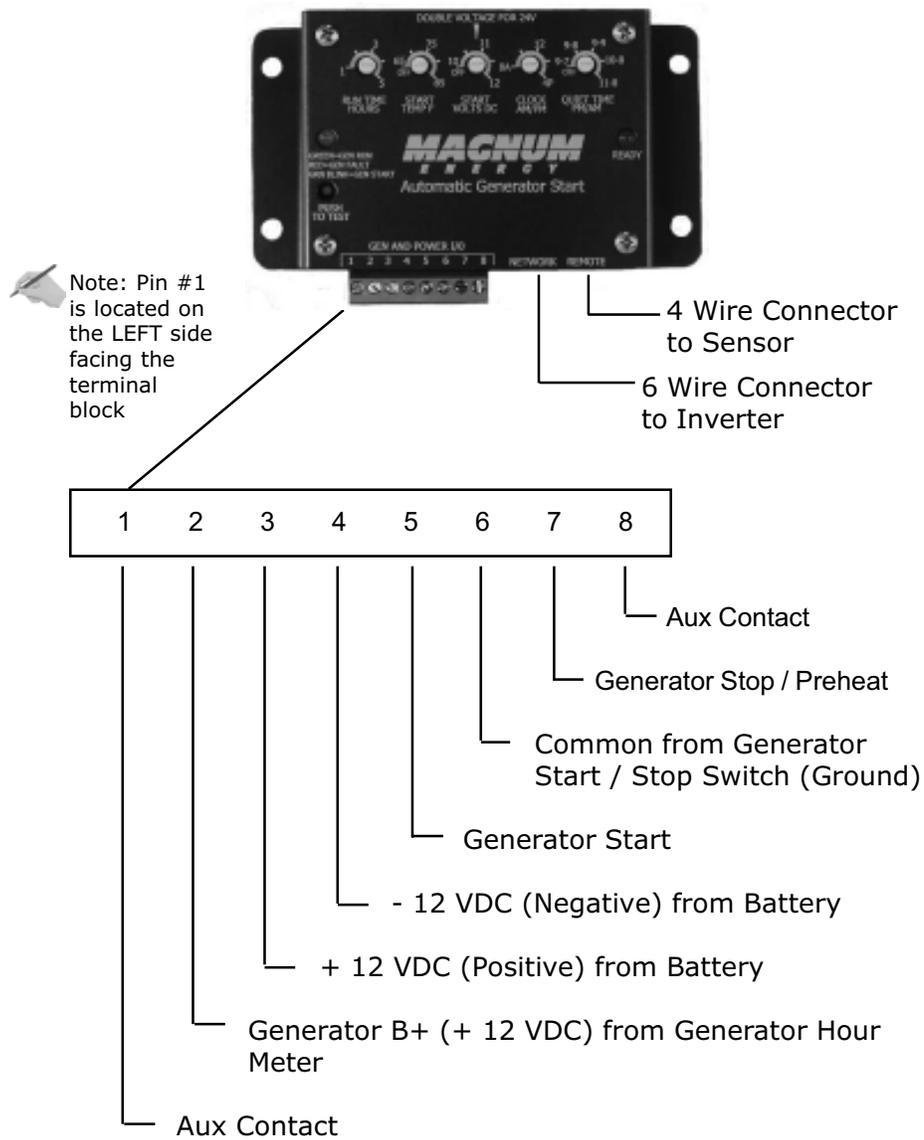
**Figure 4 - AGS Connector Pin Legend
