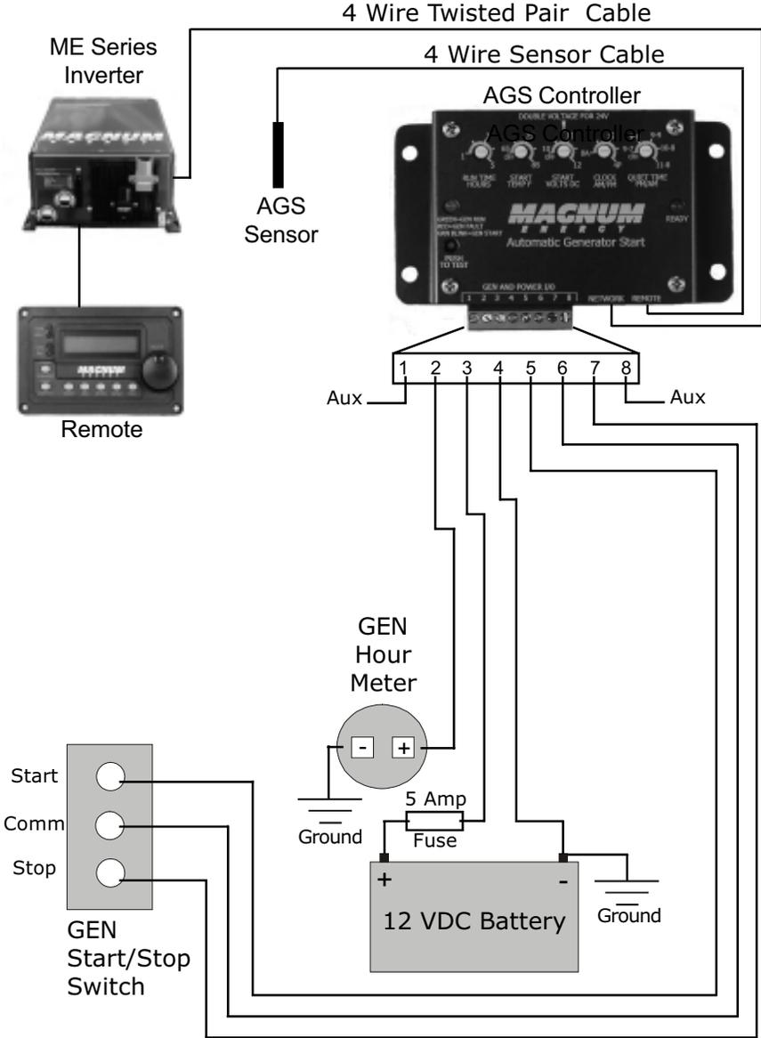
**Figure 3 - AGS Wiring Diagram**
