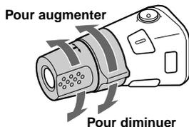
Si vous devez monter le satellite de commande du côté droit de la colonne de direction, vous pouvez inverser le sens de fonctionnement.
